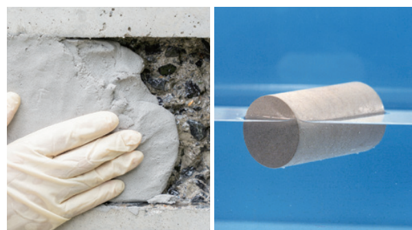
コンクリートの小断面修復材「Lパテ」（左：施工の様子、右：軽量なので水に浮いている）
