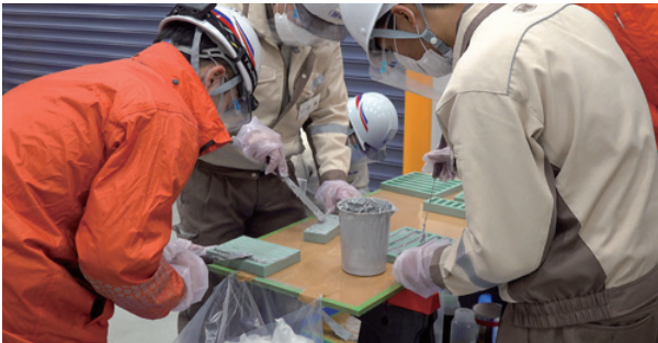
有機材料（樹脂接着剤）の供試体作製実習
