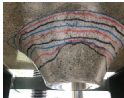
1液ウレタン樹脂を用いた透明はく落対策
